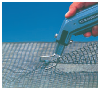
A はいずれも刃物で切断した場合 B はいずれもヒートカッターで溶断した場合
